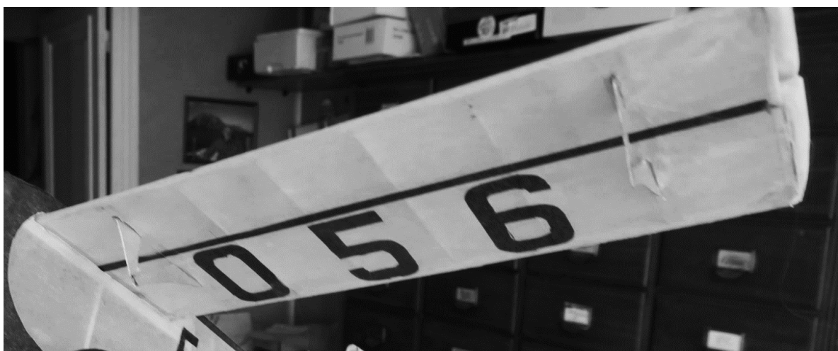
Intrados de l'aile avec les grands "compas" paliers assurant recul et rotation.
