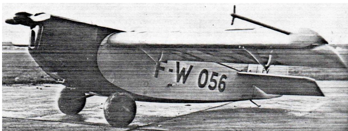
Dans la décoration du record de distance, on distingue vaguement l'immatriculation qui occupe toute la largeur de l'aile arrière et les "compas" qui assurent son déplacement.
