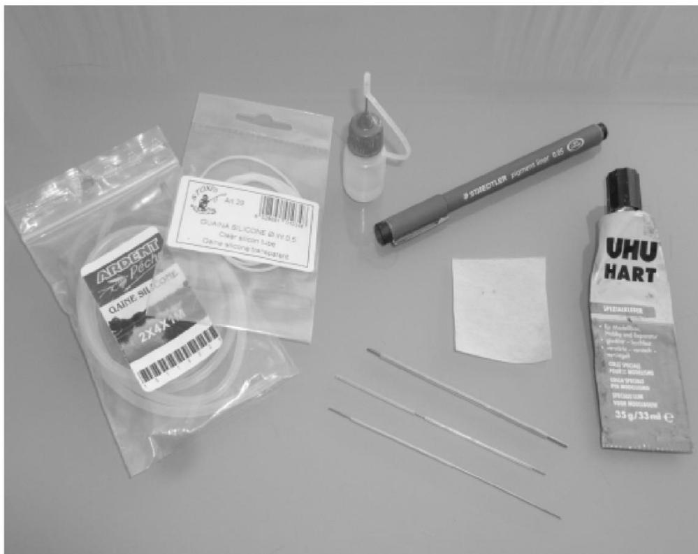
*Dans un bout de tube silicone, insérez une corde à piano de diamètre adapté pour le rigidifier.*
